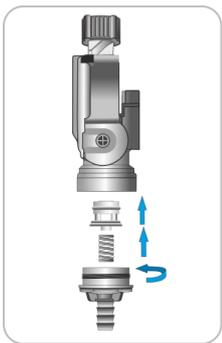
Volver a introducir la válvula en el conector, el muelle y por fin el terminal
